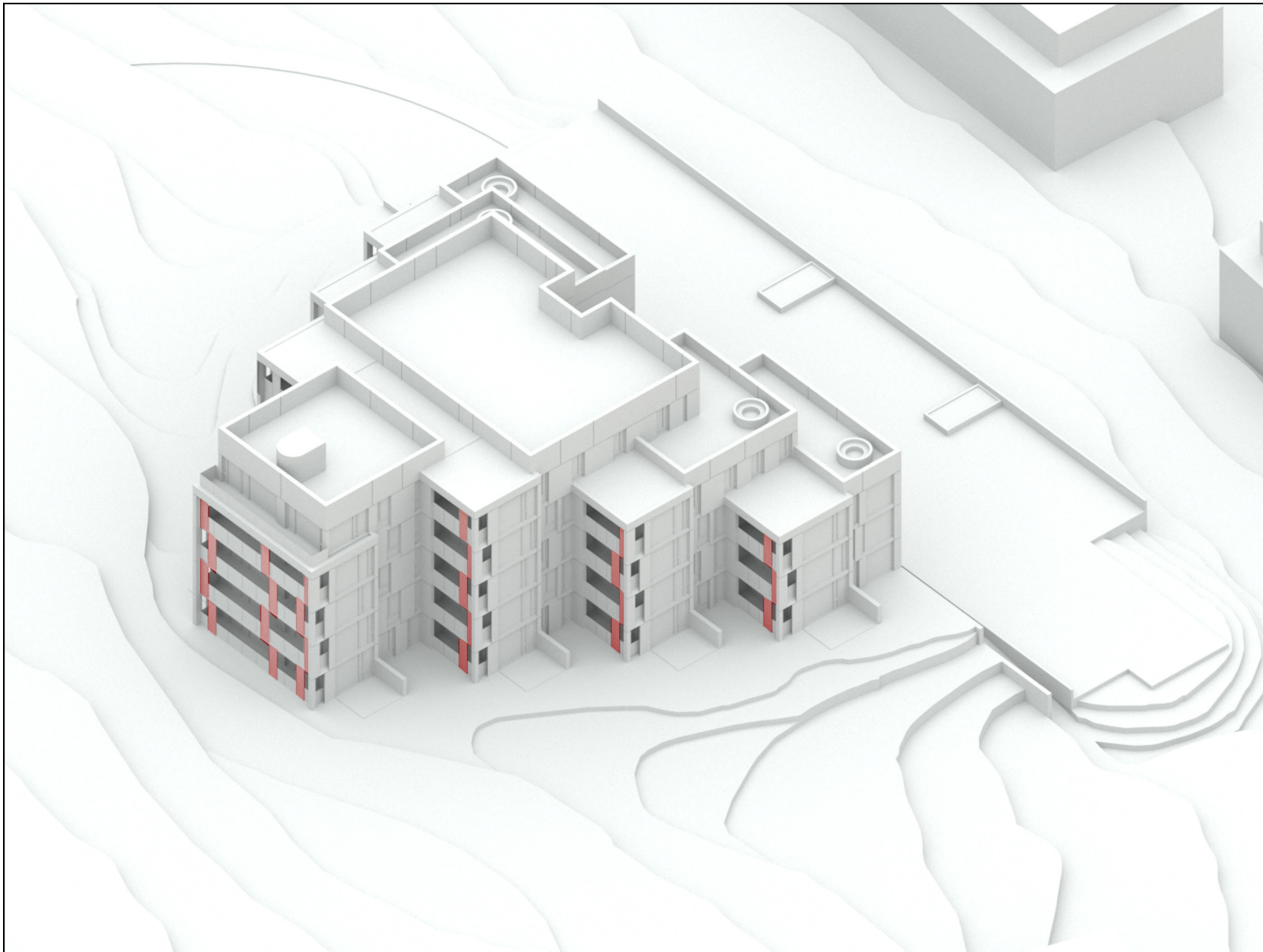
"CORTEN-STÁL" MÖSKVANET SEM UPPBROT Á SVÖLUM. EINNIG ÆTLAÐ SEM UPPISTAÐA FYRIR KLIFURJURTIR
